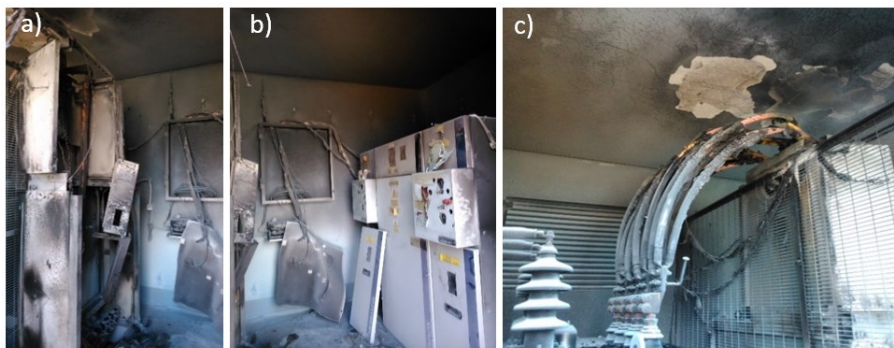
Rys. 3. Widok pomieszczeń wewnętrznej stacji transformatorowej SN/nn po pożarze: a) rozdzielnica nn, b) rozdzielnica SN, c) mosty kablowe
