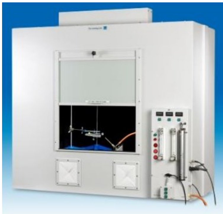
Rys. 11. Widok komory do przeprowadzania próby poziomego i pionowego palenia się zgodnie z normą PN-EN 60695-11-10:2014-02E
