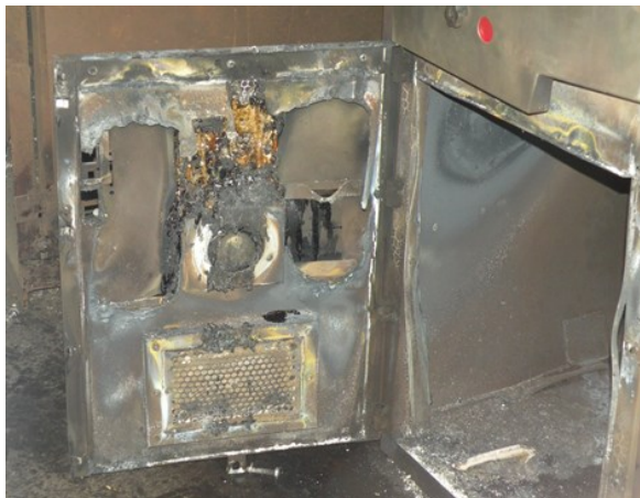
Fot. 2. Drzwi po próbie łukoochronności AFLR 31,5 kA w ciągu 1 sekundy
